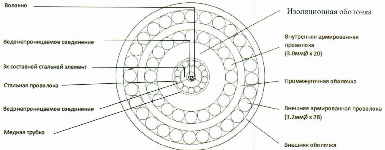
Конструкция кабеля типа DA (двубронный) включает следующие элементы:
