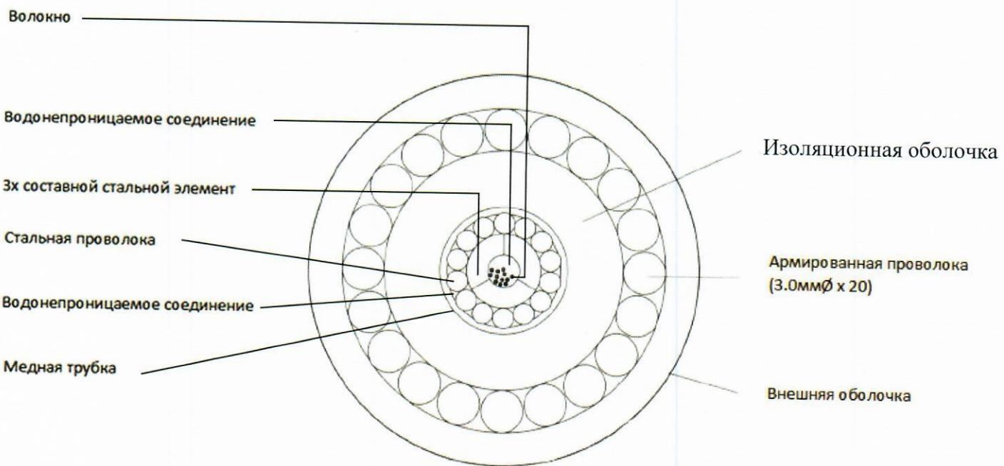
Конструкция однобронного кабеля типа SA включает следующие элементы:
